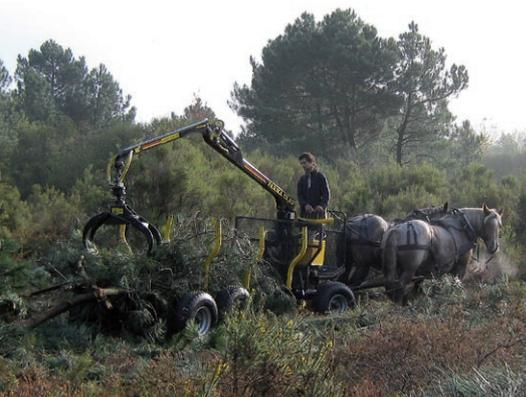
Transport de rémanents d'exploitation au porteur hippomobile à grappin.
